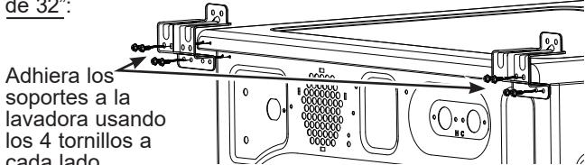
Adhiera los soportes a la lavadora usando los 4 tornillos a cada lado
