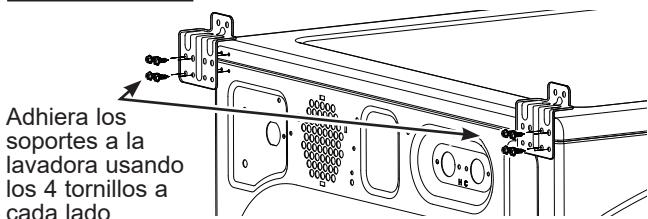
Adhiera los soportes a la lavadora usando los 4 tornillos a cada lado
