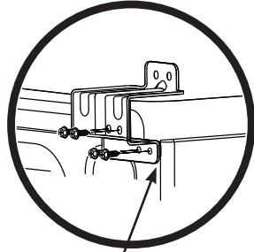
Instale el nivelador de los soportes en los extremos de las lavadoras
