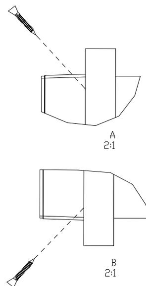
4. Fixer le cadre de la trousse de garniture à l'ouverture d'encastement/dans le placard en posant quatre vis à bois longues (peintes) dans les avant-trous percés à l'étape 3 ci-dessus.
