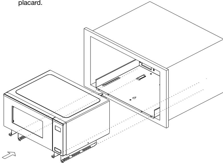
4. Fixer le four à micro-ondes à l'ouverture d'encastrement/dans le placard en installant quatre 123# courtes dans les trous de montage.
