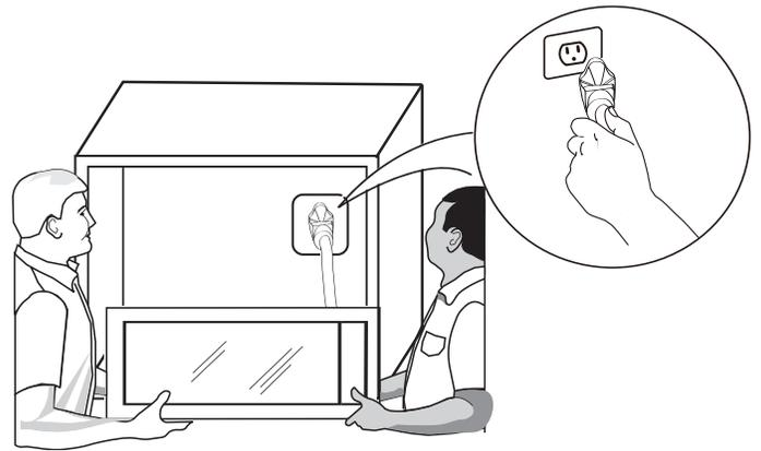
3. Réinsérer le four à micro-ondes dans l'ouverture pour le remettre en place. Les trous de montage des extrémités de glissières et du rebord du conduit inférieur s'alignent contre le bas de la face avant de l'ouverture d'encastrement/dans le placard.
