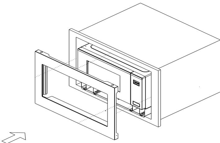
2. Pour centrer verticalement le cadre de la trousse de garniture, le plaquer contre l'ouverture et le glisser vers le haut jusqu'à ce que les languettes supérieures butent contre le haut des glissières.
