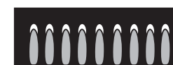
(B) Bouts des flammes jaunes sur les cônes extérieurs — Normal pour le propane (GPL)
